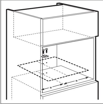
3. Zainstalować kuchenkę mikrofalową. Jeśli został zamocowany uchwyt, należy upewnić się, że blokuje on tył urządzenia.
