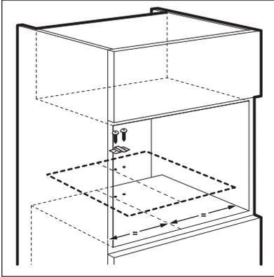
3. De magnetron installeren. Als u de beugel bevestigd hebt, zorg er dan voor dat hij aan de achterkant van het apparaat vastzit.
