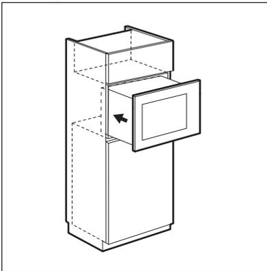
4. Otworzyć drzwi i przymocować kuchenkę mikrofalową za pomocą wkrętu.
