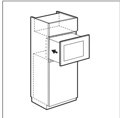
4. Öffnen Sie die Tür und befestigen Sie die Mikrowelle mit einer Schraube am Schrank.
