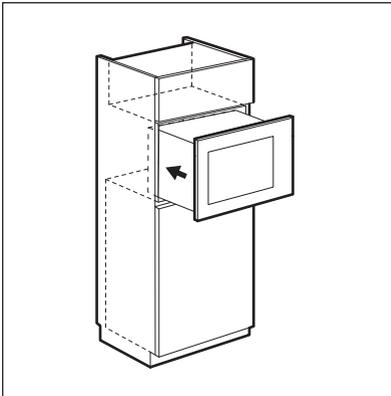
4. Open de deur en bevestig de magnetron aan de kast met een schroef.
