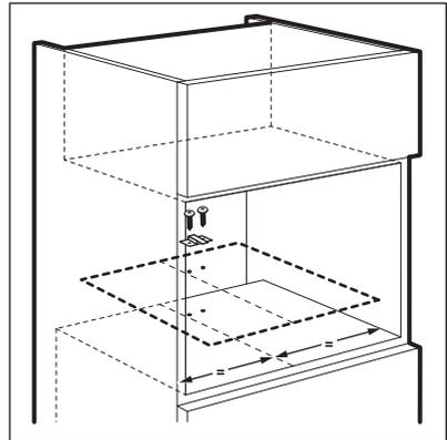
3. Installez le micro-ondes. Si vous avez vissé le support, veillez à ce qu'il bloque l'arrière de l'appareil pour l'empêcher de reculer.
